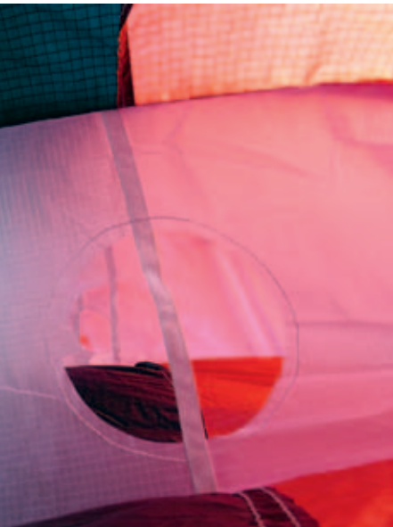
Die Luftausgleichslöcher sind umnäht und verstärkt
