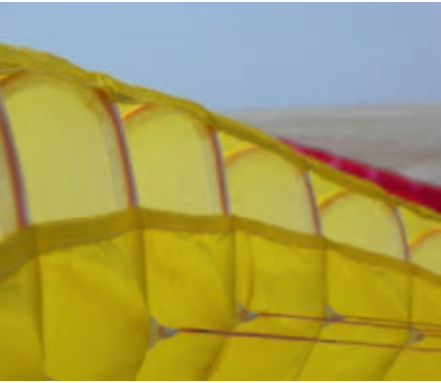
Die Profilnase ist durch Stäbchen ausgesteift
